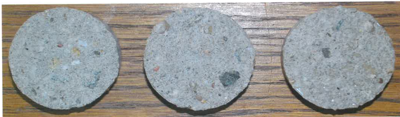
Obr. 1 Zkušební terče č. 121, 122, 123 (zkušební místo 1) po provedení odtrhu.
