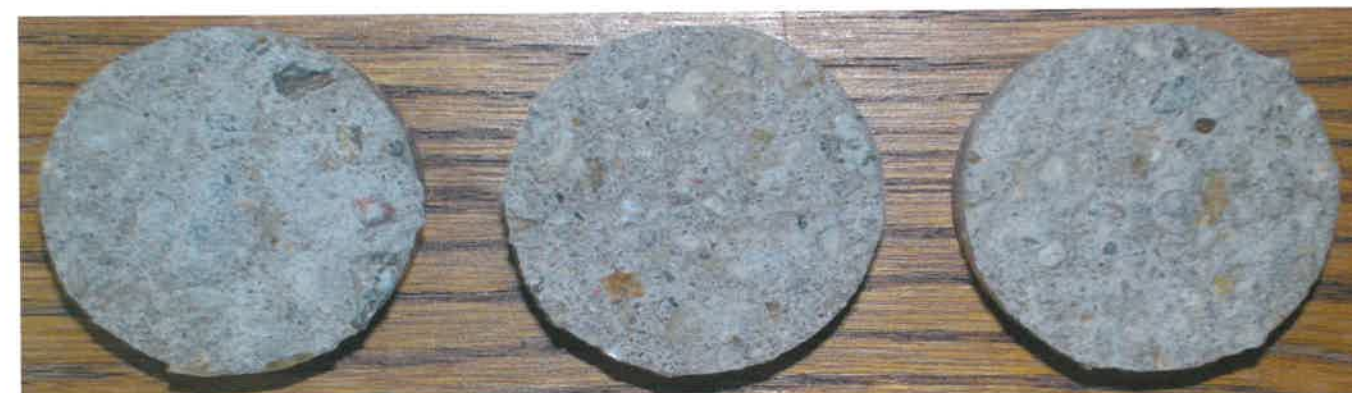
Obr. 4 Zkušební terče č. 90, 91, 102 (zkušební místo 4) po provedení odtrhu.
