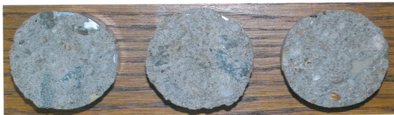
Obr. 2 Zkušební terče č. 126, 127, 128 (zkušební místo 2) po provedení odtrhu.
