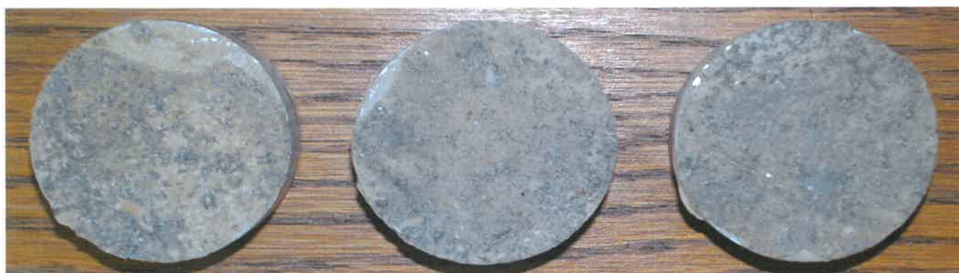
Obr. 6 Zkušební terče č. 106, 107, 108 (zkušební místo 6) po provedení odtrhu.
