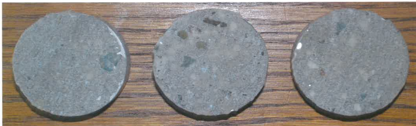
Obr. 5 Zkušební terče č. 103, 104, 105 (zkušební místo 5) po provedení odtrhu.
