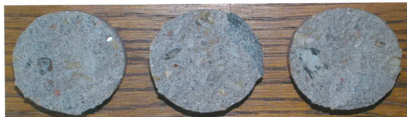
Obr. 3 Zkušební terče č. 134, 135, 136 (zkušební místo 3) po provedení odtrhu.
